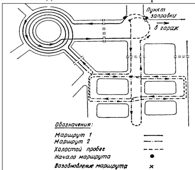
**Рис. 6.1. Образец маршрутной карты работы подметально-уборочных машин**
