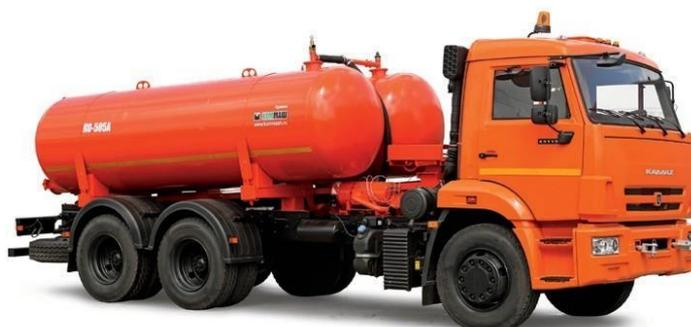
**Рис. 5.1. Вакуумная машина КО-505А на шасси КамАЗ-65115-71**
