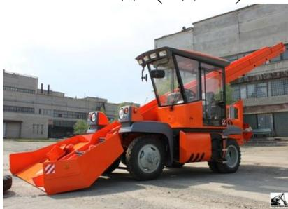
Рис. 6.20. Лаповый снегопогрузчик КО-206.
